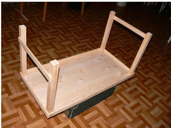
Su tutti e quattro gli angoli delle tavole di base, attaccare dal fondo con viti (lunghezze da 5 a 7 cm) pilastri verticali. Un bullone al centro della colonna è sufficiente. Quando si posizionano i pilastri, è necessario tenerli lontani dai bordi tanto quanto lo spessore delle
